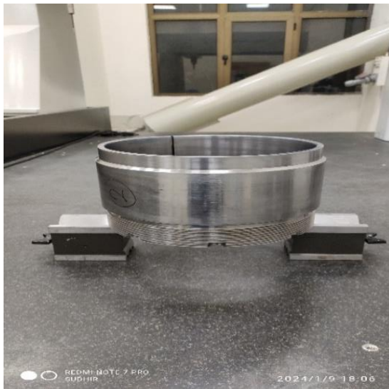
सस्पेंशन ट्यूब का निरीक्षण
